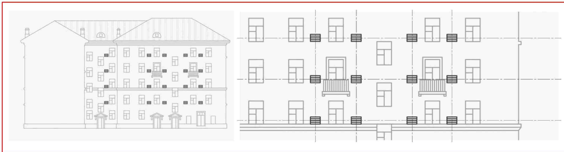
Пример правильного размещения кондиционеров на внутридвором фасаде
